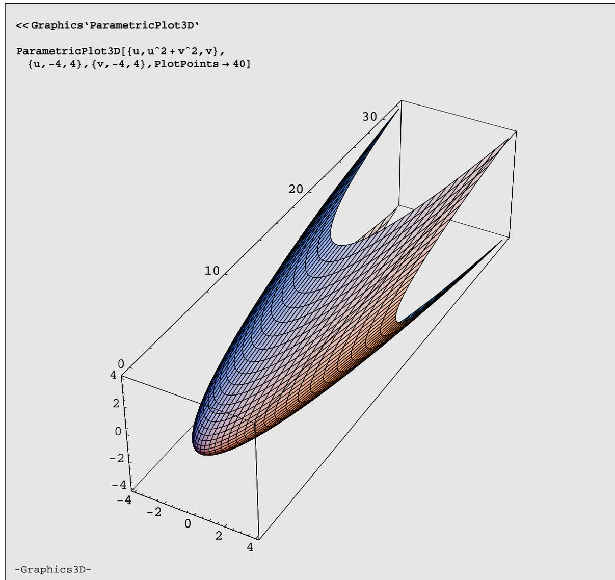
Paraboloide di rotazione di asse l'asse  $y$ .
