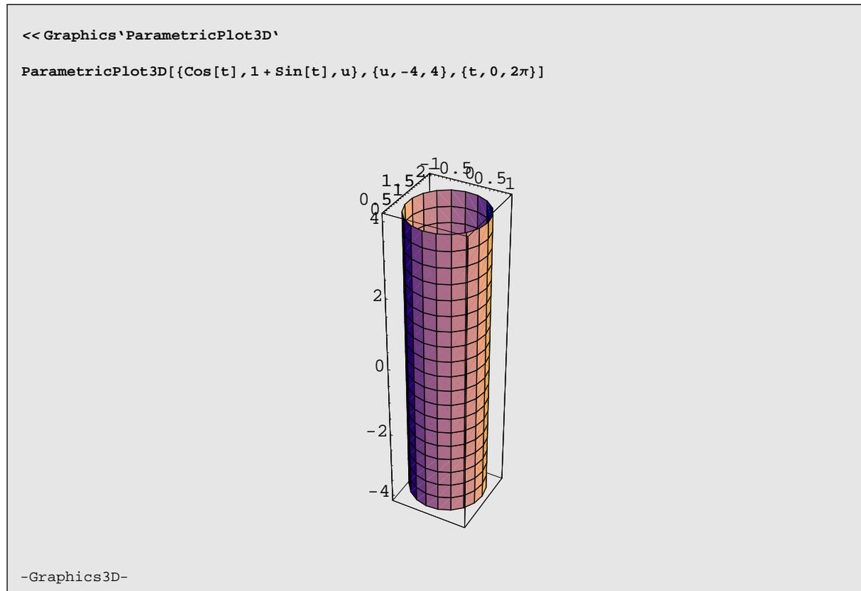
Cilindro rotondo di direttrice la circonferenza del piano  $xy$  di equazione  $x^2 + (y - 1)^2 = 1$  e generatrici parallele all'asse  $z$ .
