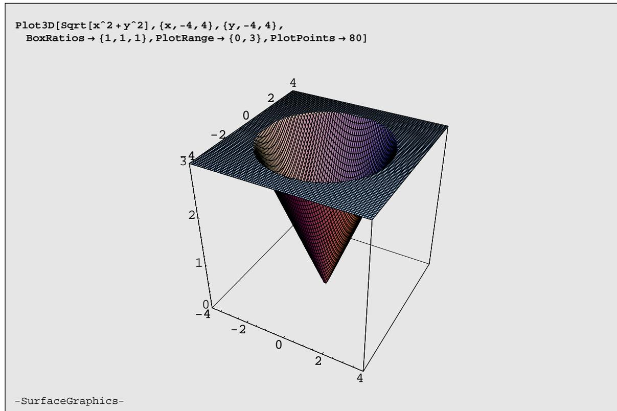
Si tratta della metà (rivolta verso l'alto) di un cono rotondo di vertice l'origine e asse l'asse  $z$ .
